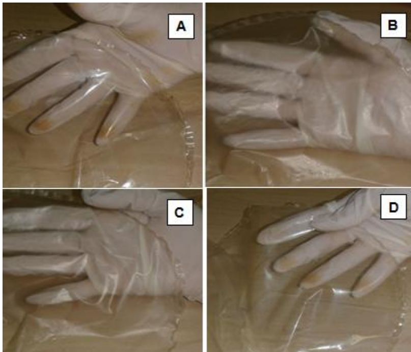
Figura 10. Fotografias mostrando a transparência dos filmes: A) filme somente com proteína miofibrilar liofilizada (PML); filmes com PML, SDS e ácidos graxos: B) esteárico; C) palmítico e C) capróico.
